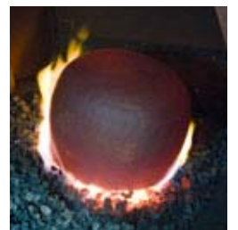
(上) 金づちで底の丸みを整えていく。 (中) 「あてがね」と呼ぶ台。これに下向きに乗せて打つ。 (下) 炉で真っ赤になるまで焼き鈍しをする。
