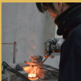
この日は、高周波炉で銅合金を溶解。金属の状態をチェックする。
