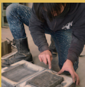
原型は工房で制作し、型づくりや鑄造を高岡市デザイン・工芸センターで行う。
