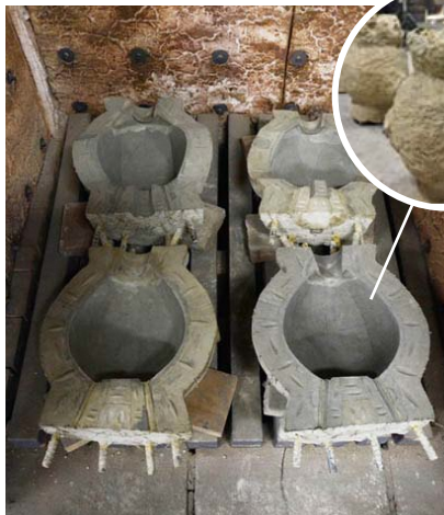
焼型鑄造法の鑄型。「寄せ」という部分的な鑄型を組み 合わせることで複雑な形状を再現できるため、古くか ら仏像や人物の銅像などの製造に用いられる。
